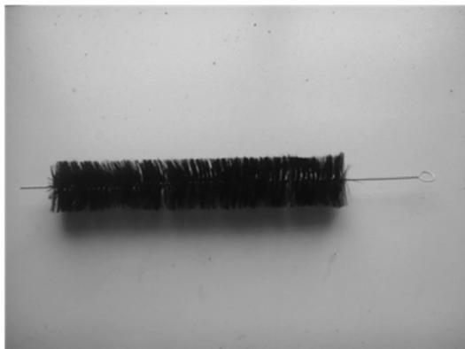
图1 氧化碳纤维刷(CFB)电极照片
