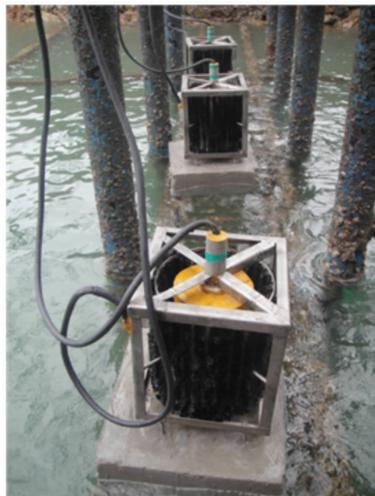
图2 3台实海测试 SWB-EC 样机照片
