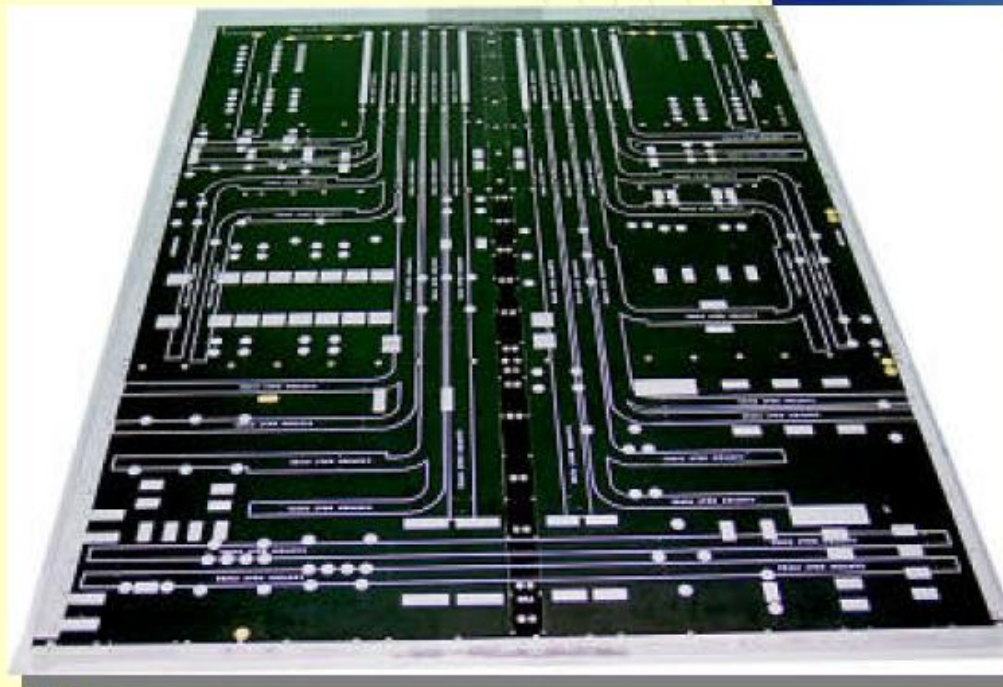
Telecom Panel Heat Pipe (Swales)
