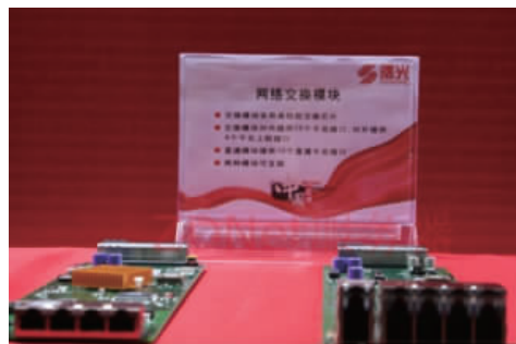
图 5 曙光 5000A 的网络交换模块
