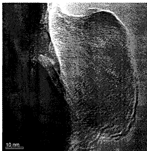
图 6 方解石(深色者)晶界间一个石墨颗粒(浅色者)的高倍图像
