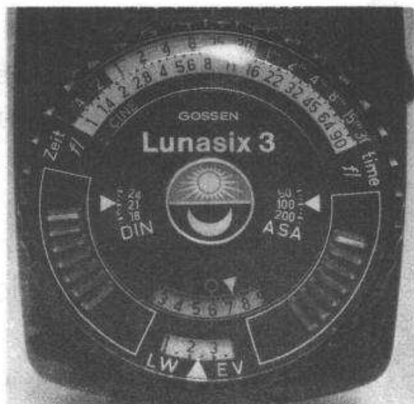
图 3-7 曝光组合旋盘
