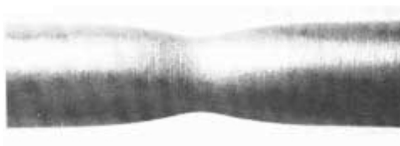
图 4 拉伸试样的颈缩
